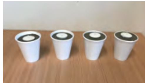
4. Schrëtt Huel de Beton aus dem Becher eraus. Wann et net gutt geet, dann huel eng Schéier a schneit de Becher futti.
